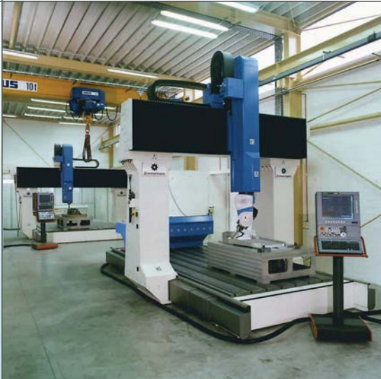
CNC-Portalfräsmaschinen 4- und 5-Achs.
