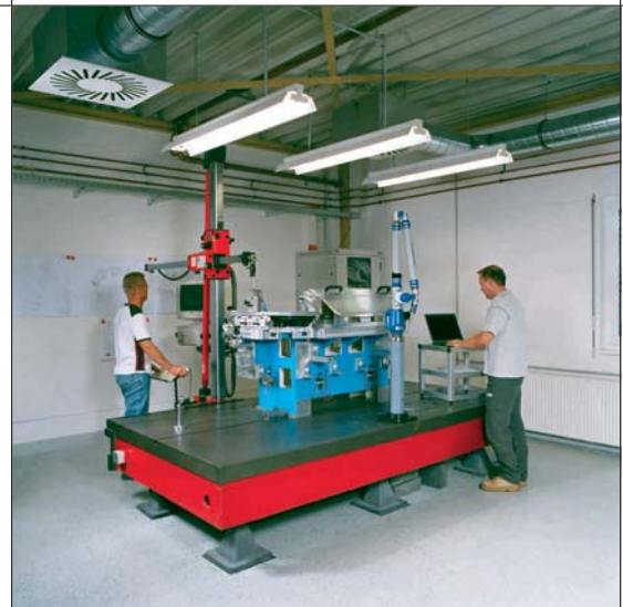
3-D-Messtechnik im Klimaraum.
