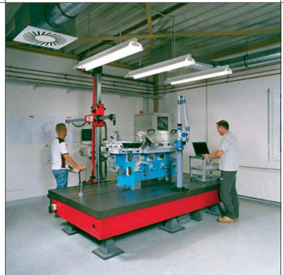
3-D-Messtechnik im Klimaraum.
