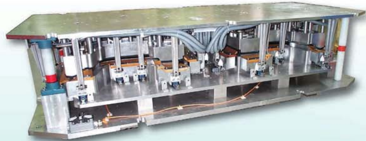
Umbug-Werkzeug einer Türinnenverkleidung.
